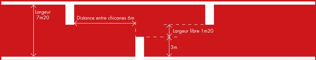
Dispositifs de chicane permettant de contenir le flux de véhicules, le fluidifier.
